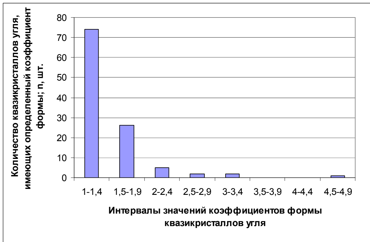
Рис. 8 – График распределения квазикристаллов угля по коэффициентам формы в пробах, отобранных при прохождении выработки (шх. им. Л.И. Лутугина)
