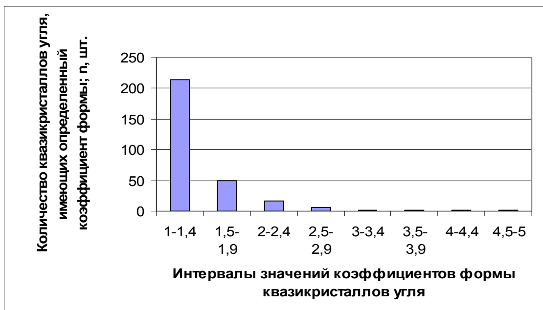
Рис. 6 – График распределения квазикристаллов угля по коэффициентам формы в пробах, отобранных на шахте «Октябрьский рудник»
